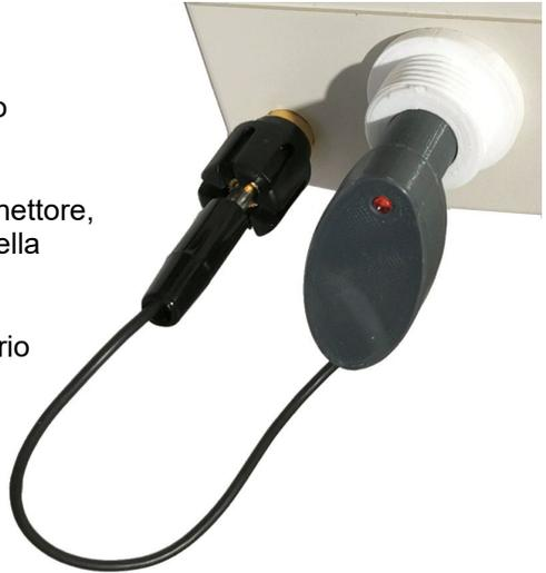
Per evitare la rottura dell'ago e/o il danneggiamento della superficie dell'elettrodo, posizionare l'elettrodo in posizione centrale PRIMA di inserire il nuovo ago
